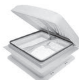
X805362 Lanterneau à aération permanente (220 cm 2 ) 360x360, ouverture par manivelle. Avec moustiquaire détachable
