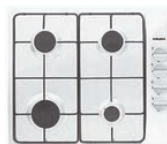
X820750 Table de cuisson émail au gaz naturel 60 cm Dim. 42 x 560 x 480 mm / hors tout : 87 (avec grilles) x 590 x 505 mm Puissance : 0,6 W – Manettes latérales, allumage une main, sécurité thermocouples, grilles émaillées
